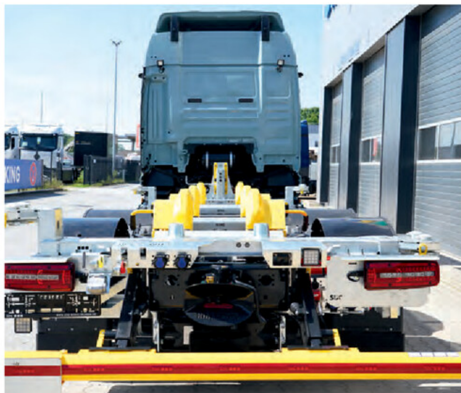
Das modulare Fahrgestellkonzept und der höhenverstellbare Tragarm HV180 erlauben je nach Bereifung variable Abstellhöhen.
