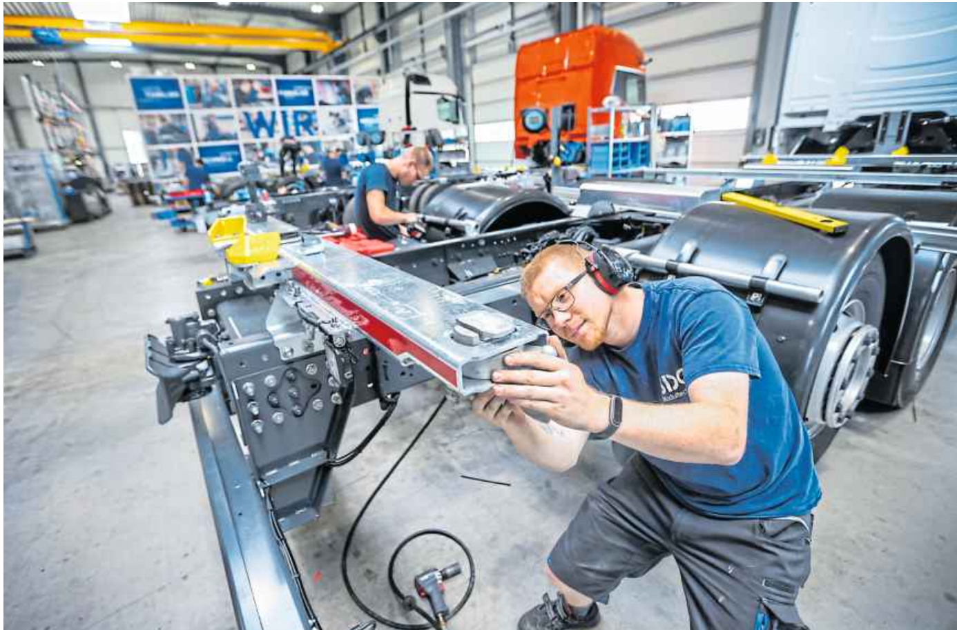
Frank Wins (vorne) montiert an das Fahrgestell eines Lkw ein Trägersystem für abnehmbare Transportbehälter.
