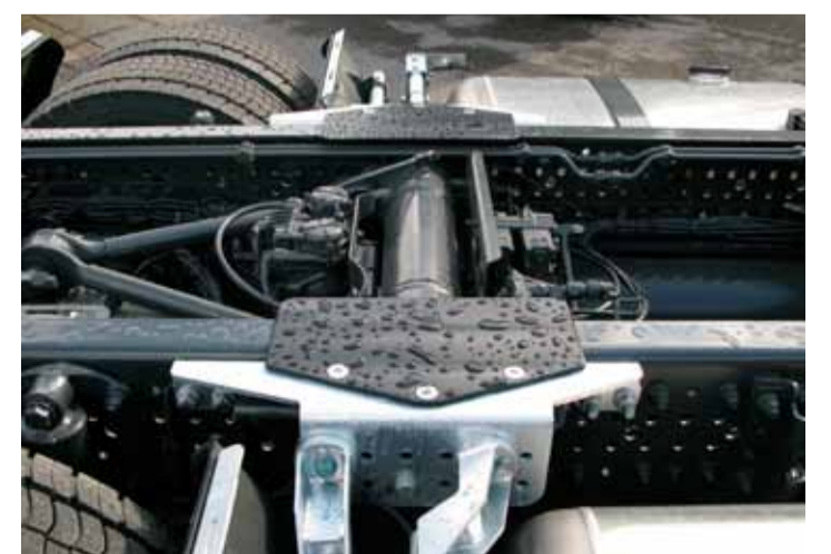
Geräuschdämmung: Am Rahmen befestigte Kunststoffplatten sollen Lärm beim Aufbrücken mindern.
