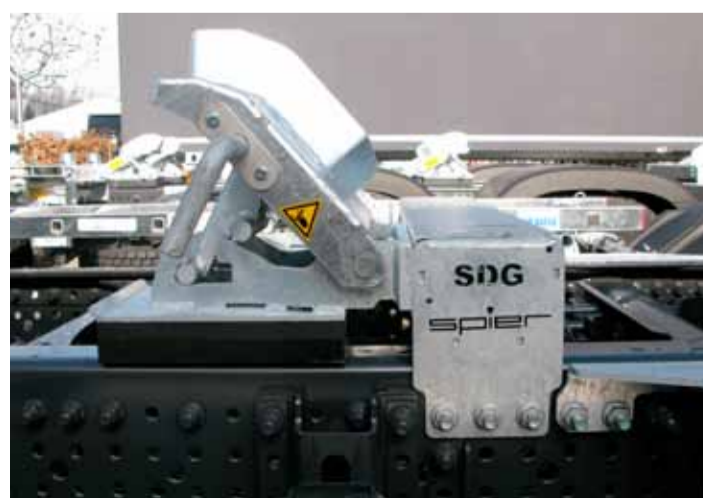
Flexibel: Mit Hilfe der dreistufigen Höhenverstellung passen Abstellhöhen zwischen 1.020 und 1.200 mm auf ein Fahrzeug.
